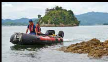
岸壁への接近もペラが無いジェット船外機だから安心
